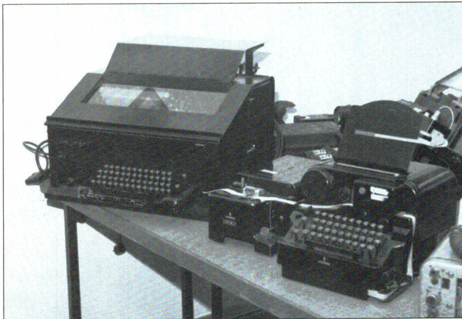
Telexapparatuur in de DELM collectie. Links de bekende Siemens T-37 bladschrijver. Dit type werd voor WO-II al gebruikt bij de PTT en het leger. Bij amateurs is dit apparaat bekend geworden onder de naam 'Wortelstamper' vanwege het stampende geluid en de zware aanslag van de afdrukhamertjes. Daarnaast de Siemens ponsbandlezer T-61. Geheel rechts de Siemens bandschrijver T-68, waarbij het bericht werd afgedrukt op de ponsband
